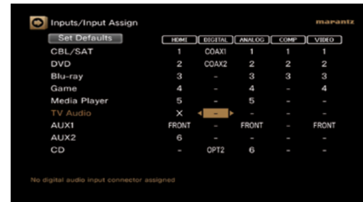
Izgled AV priključaka za svaki pojedini ulaz
