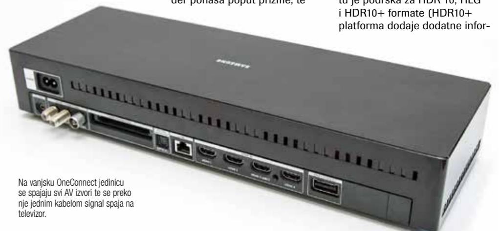
Na vanjsku OneConnect jedinicu se spajaju svi AV izvori te se preko nje jednim kabelom signal spaja na televizor.
