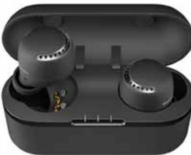
S druge strane slušalice su zato puno kvalitetnije izrađene. Dimenzija 30 x 21 x 31 mm (VŠD), ugodno su okrugle, izrađene od mekane mat plastike s metalnim ukrasom s prstenom po rubovima. Rupe na ovoj metalnoj traci sadrže LED diode i mikrofone potrebne za uklanjanje buke, što je vrlo atraktivna način kombiniranja oblika i funkcije. Unatoč rupama, RZ-S500W imaju IPX4 certifikat što znači da su otporne na prskanje vode.
