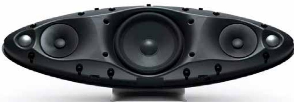
U samom kućištu uređaja nalazi se pregršt moderne tehnologije. Uz DSP te izlazna pojačala ukupne snage 240W, nalazimo i stereo zvučnike, dvo-sistemske, koji se sastoje od visokotonca dvostrukre kupole promjera 25 mm, poput onoga u seriji 600 i FST srednjetonca promjera 90 mm. Ovi stereo zvučnici potpomognuti su subwooferom promjera 150 mm, što bi uz ugradeni DSP i dinamičku ekvalizaciju trebalo omogućiti deklarirani frekvencijski opseg raspona 35Hz do 24kHz. Time dolazimo i do zvuka. U
